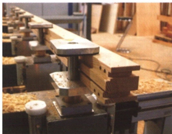
Am aufgespannten Werkstück werden die Längs- und Konterprofilierung sowie die Dübelbohrungen ausgeführt.
