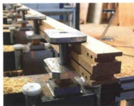
In einer Aufspannung: Längsprofilierung, Konterprofilierung und Dübelbohren
